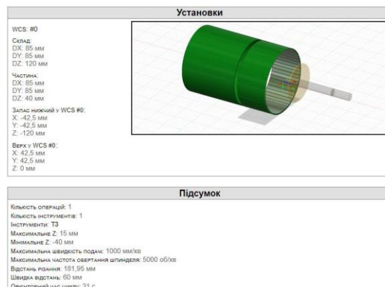
Рисунок 3 - Результати моделювання відрізання фрезою зсередини
